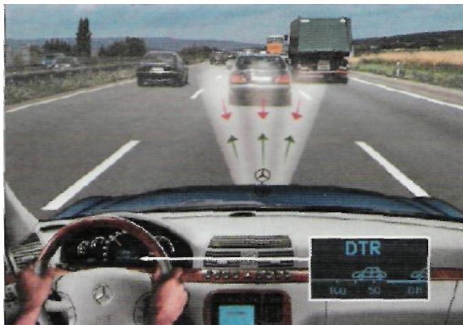
Figura 7.6. Principios del ACC
