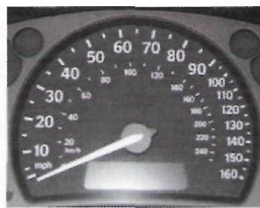
Figura 7.3. Velocímetro con escala variable
